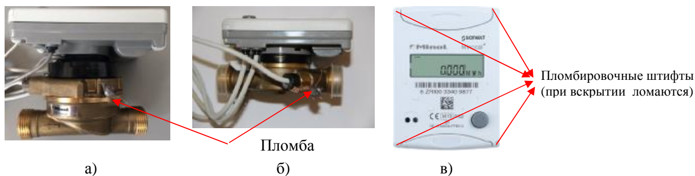
Рисунок 1 - Теплосчётчики Sanext а) Теплосчётчики Sanext CMF Combi б) Теплосчётчики Sanext ISF Mono в) Вычислитель
