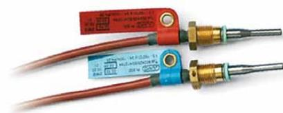
Датчик отличается оптимизированной характеристикой отклика на изменение температуры измеряемой среды. AGFW-датчики разрешается встраивать только непосредственно погружёнными в измеряемую среду, встраивание погружных гильз невозможно. Этот тип поставляется в виде РТ100, РТ500 или РТ1000.
